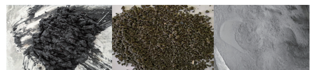
a. 含水率为80%污泥 b. 干化后污泥 c. 气化灰渣
