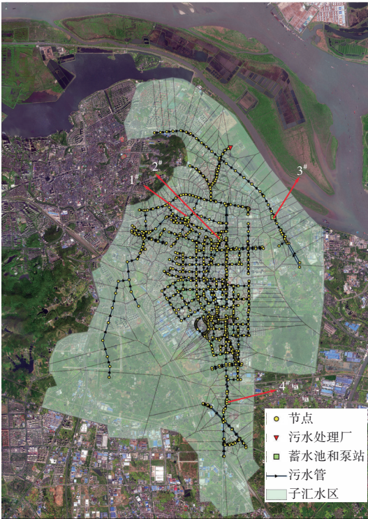
图1 研究区域的排水管网模型
