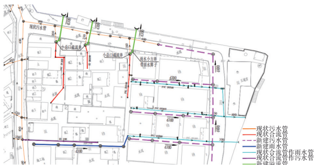
图4 城中村雨污分流改造
