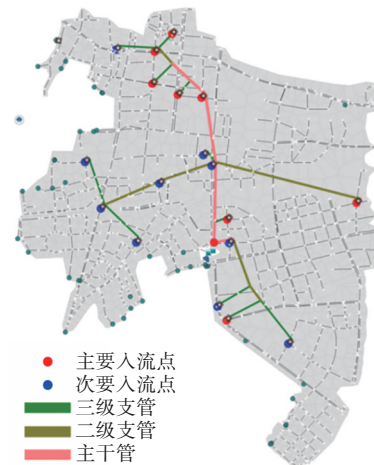
图7 深隧管道布置
