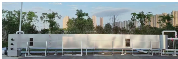
图1 污水管道沉积-冲刷试验装置
