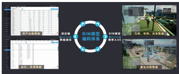
b. 基于BIM模型编码体系的数模分离技术路线
